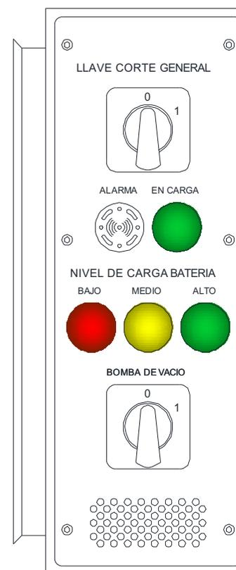
En estado normal de trabajo, el panel del equipo indica permanentemente el nivel de carga de la batería, encendiendo uno a uno los pilotos lumínicos. Siendo para “Nivel Alto” el color verde, “Nivel Medio” el color amarillo y “Nivel Bajo” el color rojo.
