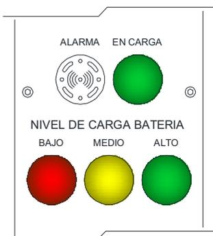
El cargador automático del equipo, detecta la alimentación externa y comienza a cargar la batería. Se puede ver el piloto luminoso “En Carga” indicando dicha operación con parpadeo cada 1 segundo aproximadamente. Una vez finalizada la operación de carga, el piloto luminoso “En Carga” dejará de parpadear, avisando que la batería se encuentra a un nivel óptimo para su uso.
